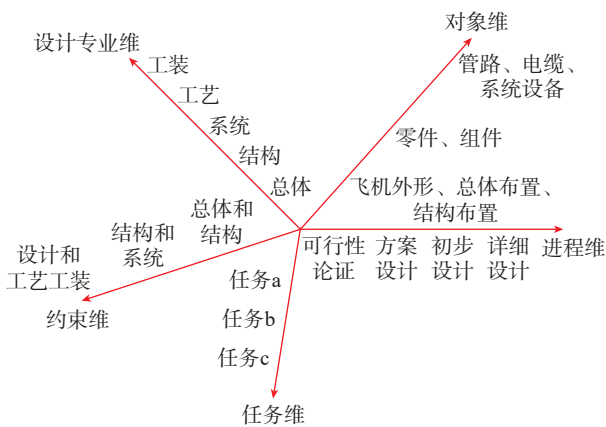
图6 航空产品协同设计的多维度模型
